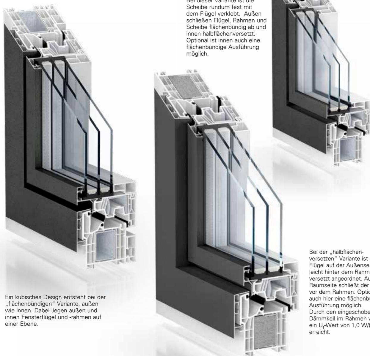
Bei dieser Variante ist die Scheibe rundum fest mit dem Flügel verklebt. Außen schließen Flügel, Rahmen und Scheibe flächenbündig ab und innen halbflächenversetzt. Optional ist innen auch eine flächenbündige Ausführung möglich.
